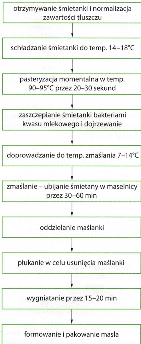
Ryc. 5.2. Etapy produkcji masła metodą tradycyjną [15]
