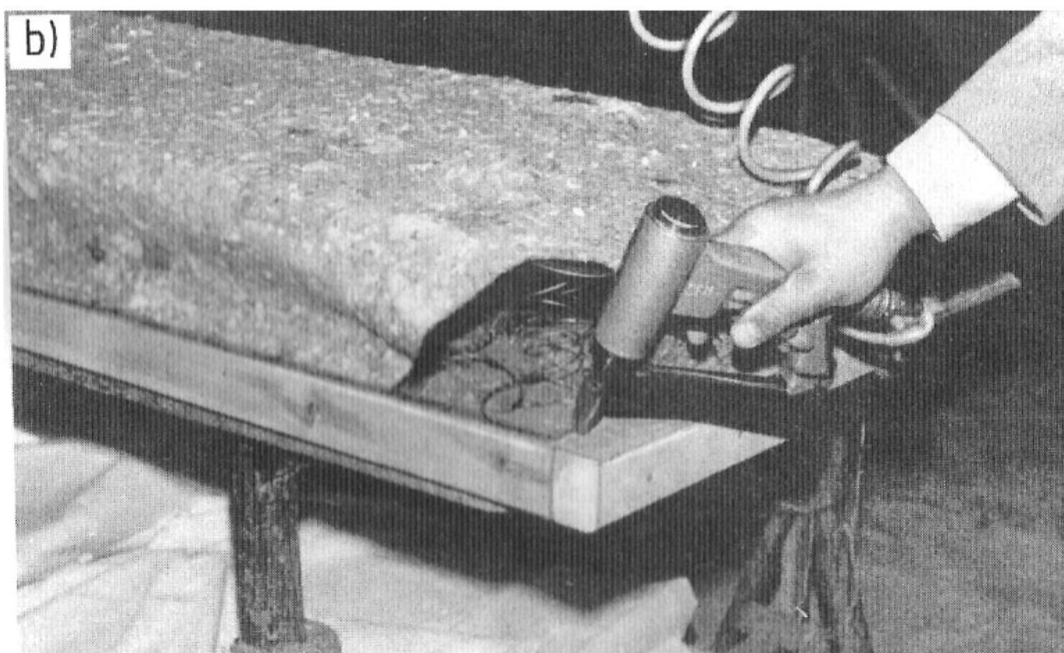
Rys. 20. Mocowanie tkaniny jutowej do ramy a) za pomocą gwoździ tapierskich, b) zszywkami [3, s.118]
