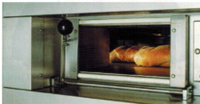
Ryc. 3.41. Okna rewizyjne w piecu tunelowym
