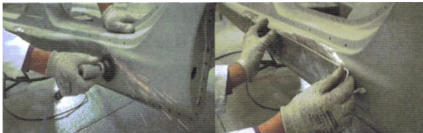
1. Usunięcie powłok lakierniczych. 2. Oględziny uszkodzenia.
