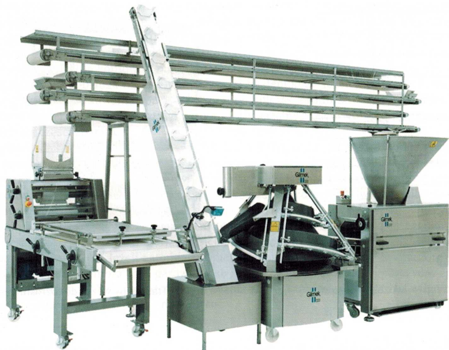
Ryc. 2.16. Linia do produkcji chleba z międygarownią podsufitową
