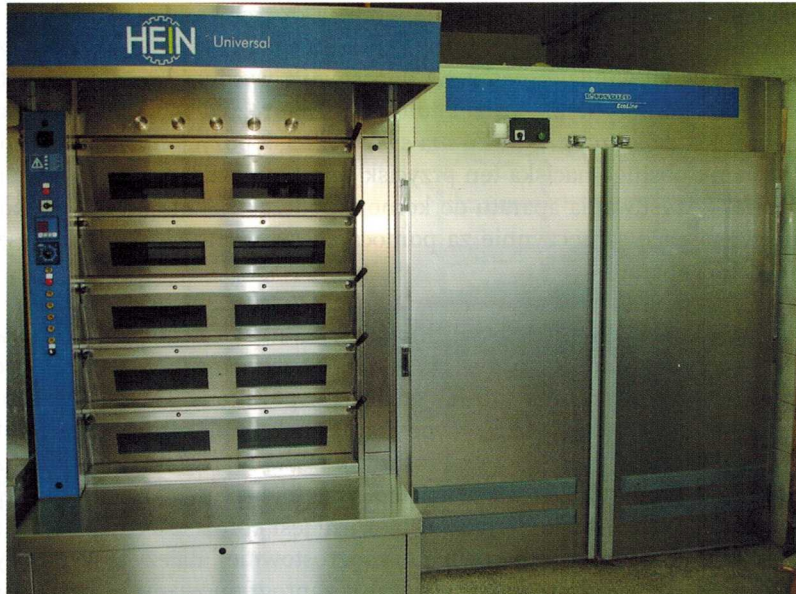
Ryc. 2.24. Widok komory garowniczej umiejscowionej obok pieca
