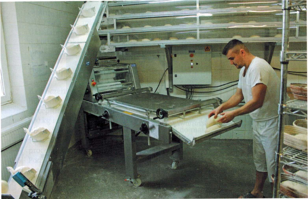
Ryc. 2.14. Podsufitowy transporter rozrostowy
