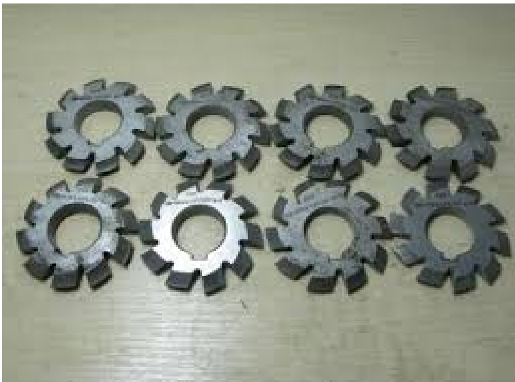
Rys. 24 Frezy modułowe krążkowe NFMa 4,5/20 zestaw 8 szt.
