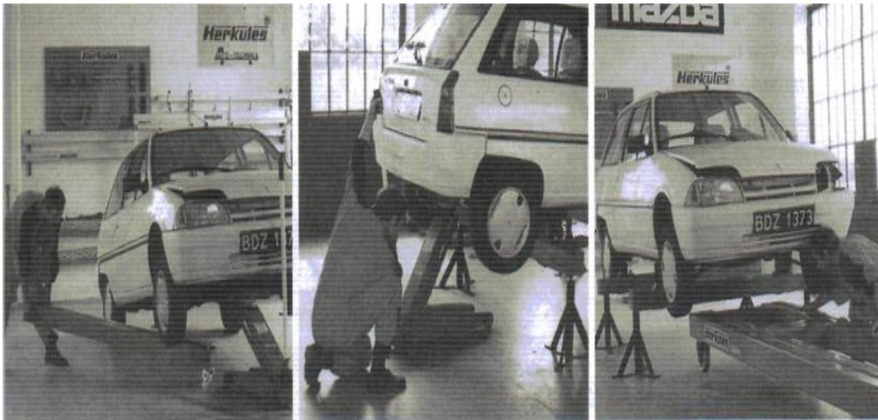
Montaż przy zastosowaniu przesuwne podnośnika warsztatowego
