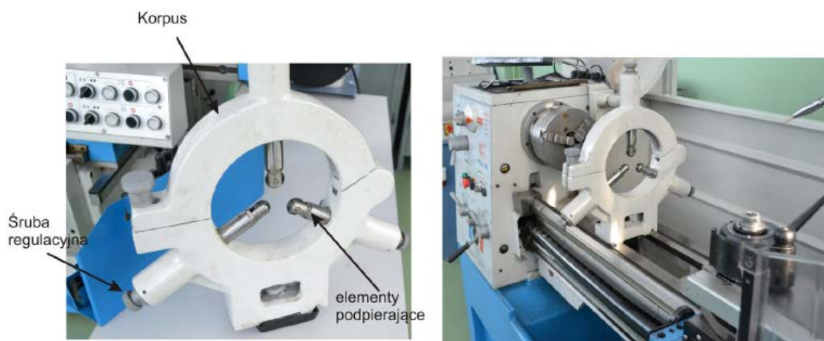
Rys. 5. Podtrzymka stała budowa i usytuowanie na tokarce.
