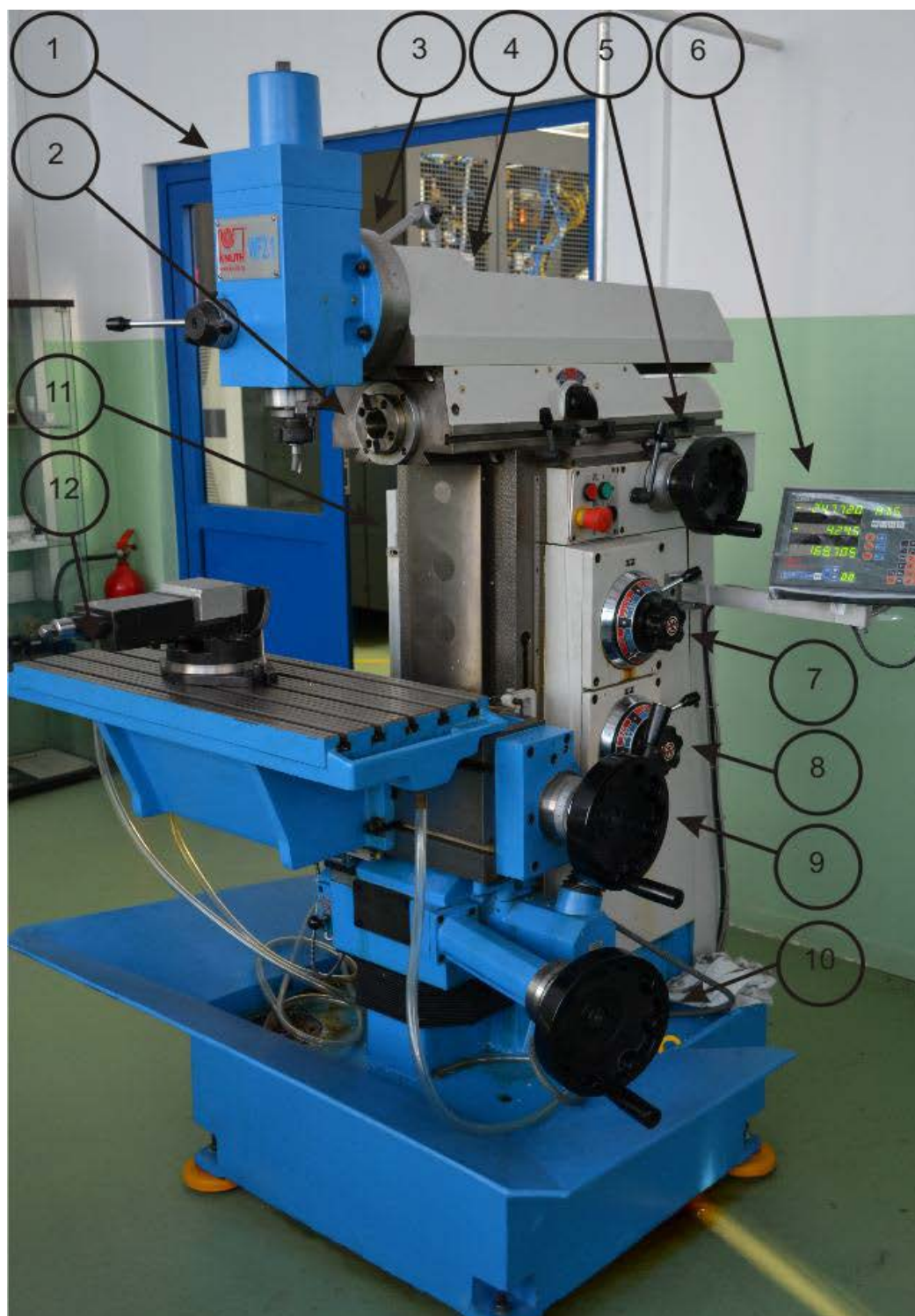
Rys. 9. Budowa uniwersalnej frezarki wspornikowej: 1-wrzeciono pionowe, 2- wrzeciono poziome, 3- podziałka skreću osi pionowej wrzeciona, 4- belka wspornikowa, 5 posuw ręczny poprzeczny, 6 – wyświetlacz pozycji, 7 – skrzynka prędkości obrotowej wrzeciona, 8 – skrzynka posuwów, 9 – posuw ręczny wzdłużny, 10 – posuw ręczny pionowy, 11 – korpus, 12 – wspornik
