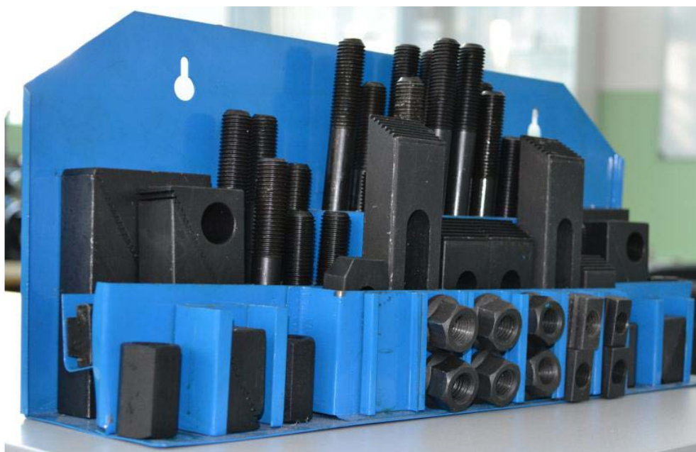
Rys. 13 Zestaw do bezpośredniego mocowanie przedmiotu.
