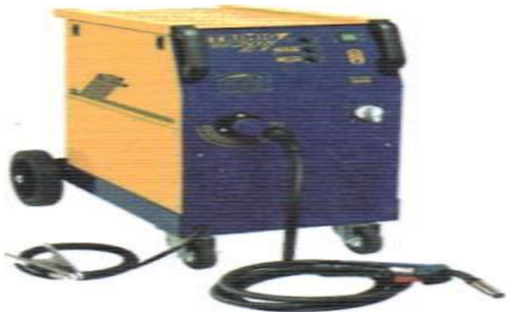
Spawarka przeznaczona do łączenia blach karoseryjnych podczas napraw blacharskich. Prąd spawania od 15+200A (GYS)
